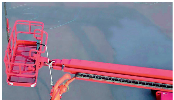
Bildfolge: Ausschnitte aus einem Video über Dummy-Versuche zu den Unfallszenarien an Hubarbeitsbühnen. Dargestellt wird der Unfallmechanismus bei einem Katapulteffekt mit falsch eingestelltem Verbindungsmittel.
