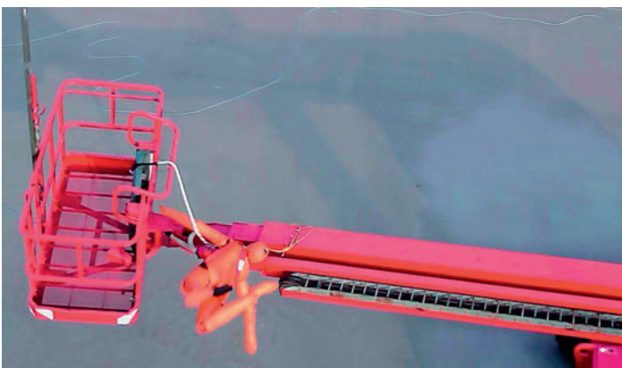
Bildfolge: Ausschnitte aus einem Video über Dummy-Versuche zu den Unfallszenarien an Hubarbeitsbühnen. Dargestellt wird der Unfallmechanismus bei einem Katapulteffekt mit falsch eingestelltem Verbindungsmittel.
