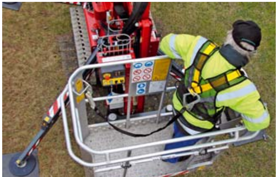
Abb. 2: Verbindungsmittel mit integriertem Falldämpfer sind nicht als Absturzsicherung auf mobilen Hubarbeitsbühnen geeignet.
