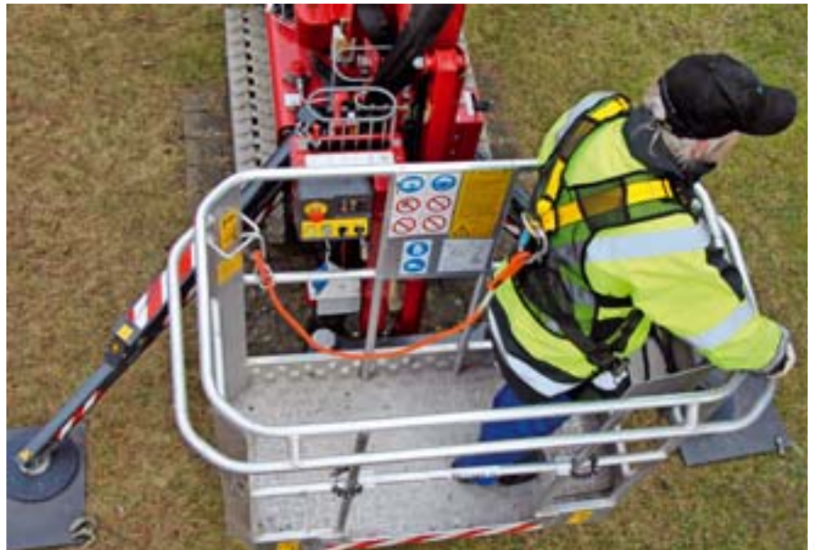
Abb. 1: Einstellbare Halteseile müssen ständig nachjustiert werden um die Fallstrecke möglichst klein zu halten.
