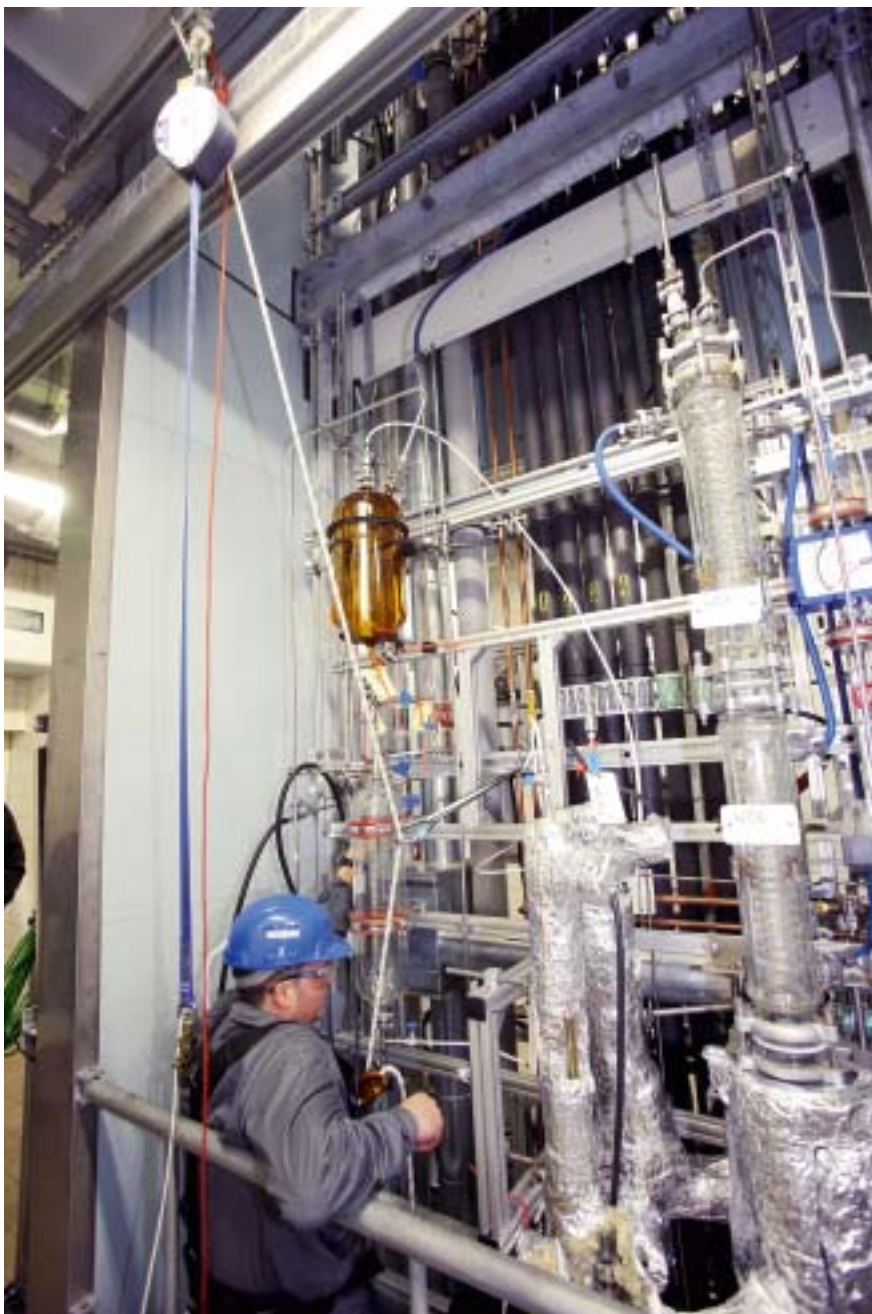
Höhensicherungsgerät und verstellbares Verbindungsmittel zur Arbeitsplatzpositionierung werden außerhalb der Apparaturen an einer Laufschiene eingehängt.
